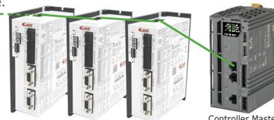
Controller Master: PLC con PowerLink
